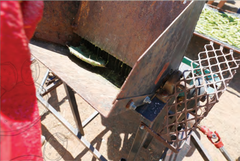
Saaglemskywe is sowat 15 mm uitmekaar op 'n as gerangskik. In die agtergrond kan die stroke op 'n droogmat gesien word. Die kerwer word deur 'n luierende trekker se kragtakker aangedryf.
