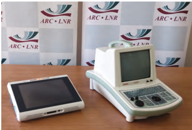
Die ou "Aquila Pro Vet" (regs) en nuwe generasie "My Lab One VET" (links) ultrasoniese skandeerders. Die ooglopende verskille is duidelik sigbaar t.o.v hanteerbaarheid en kompaktheid.
